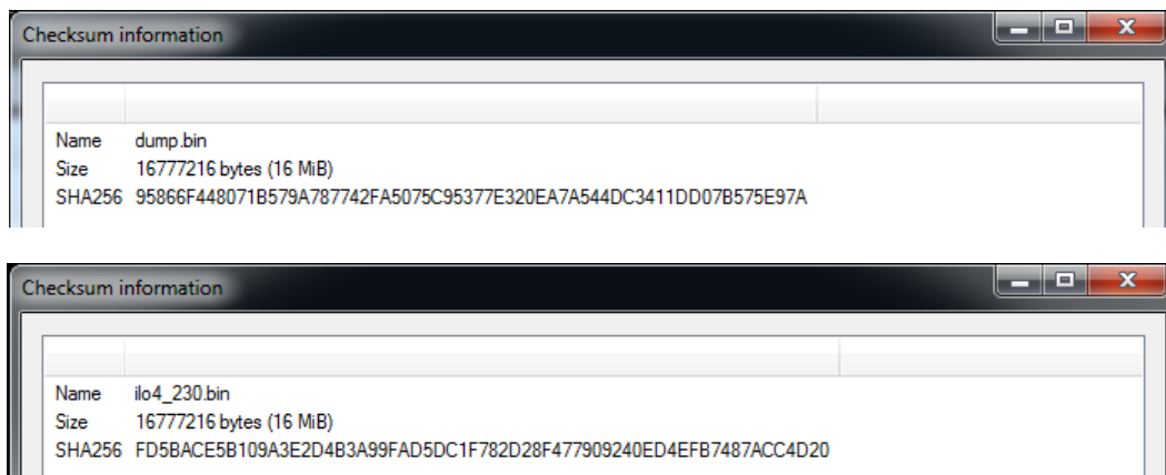
شکل ۶- اختلاف امضاء سفت افزار: (بالا) رونوشت سیستم؛ (پایین) نسخه اصلی ارائه شده توسط شرکت HP
